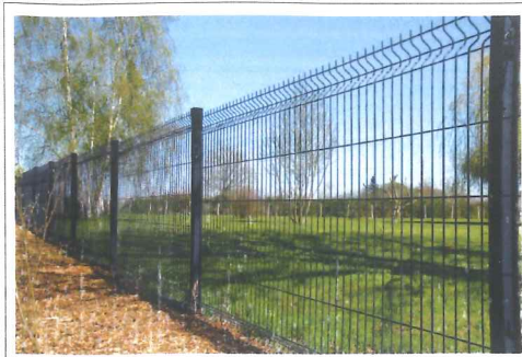
Clôture Treillis soudé maille rectangulaire (5x10cm) ep. 4mm en acier laqué à fil vertical et horizontal Hauteur clôture = 2m Teinte gris sombre
