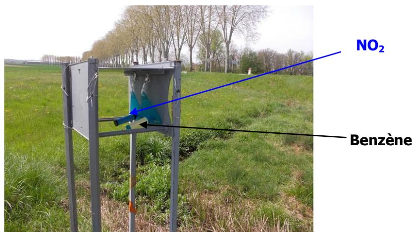
Le tube contient un adsorbant adapté pour le polluant que l'on veut mesurer. Le prélèvement de l'échantillon s'effectue par une méthode naturelle. Celle-ci repose sur le principe de la diffusion passive des molécules sur le milieu adsorbant. La quantité de polluant est proportionnelle à sa concentration dans l'environnement et est décrite par la loi de Fick simplifiée :
